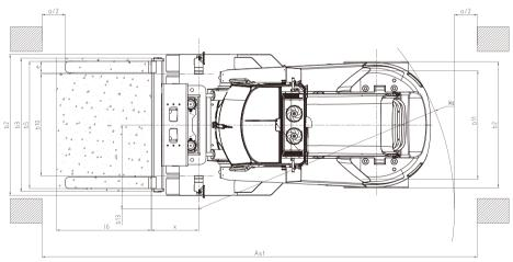
Ast=16+Wa+x+a L6: load length a: Clearance (200mm)
